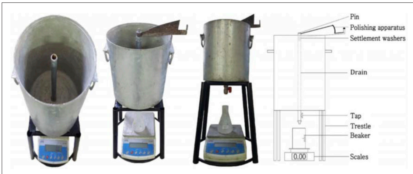
6. ábra: Módosított szabványos kivérzés mérőedény (Gökçe et al., 2018)
