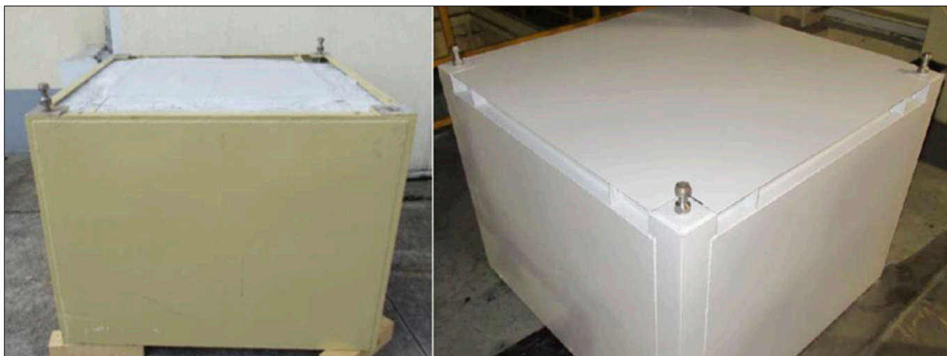
3. ábra: Cementpéppel kiöntött (inaktív) konténer (kompakt hulladékcsomag, KHCS)
