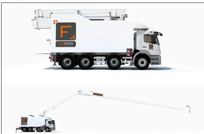
7. ábra: A Hadrian X mobil falazó robot (Designing Buildings Wiki, 2020)
