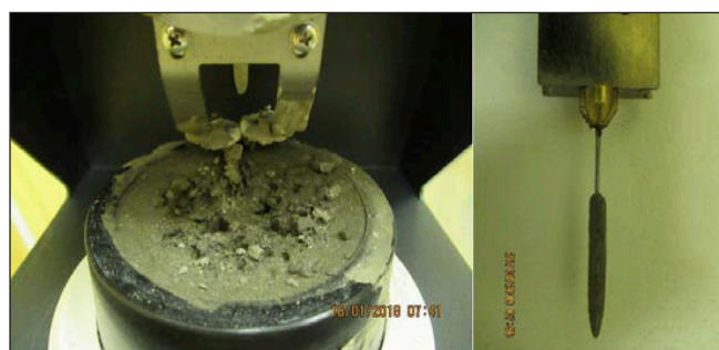
5. ábra: Radioaktív cementpép kötési idő meghatározása (hibás mérés)
